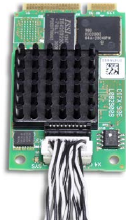
Abbildung 49: Ethernet-Aufsteckschnittstelle (AIFX-RE) an die Grundkarte CIFX 90E anschließen (Beispiel)
