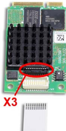
Abbildung 50: CANopen-Aufsteckschnittstelle (AIFX-CO) an die Grundkarte CIFX 90E anschließen (Beispiel für ein Gerät mit einem Kanal)
