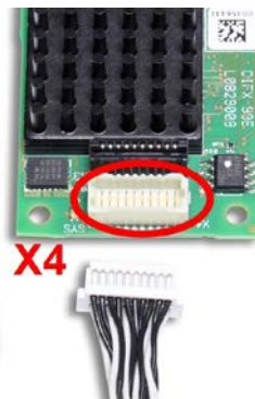
Abbildung 49: Ethernet-Aufsteckschnittstelle (AIFX-RE) an die Grundkarte CIFX 90E anschließen (Beispiel)
