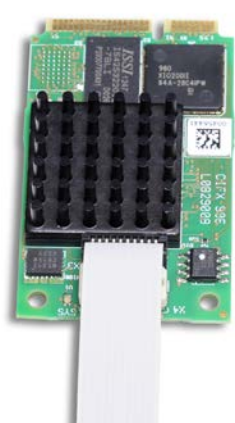
Abbildung 50: CANopen-Aufsteckschnittstelle (AIFX-CO) an die Grundkarte CIFX 90E anschließen (Beispiel für ein Gerät mit einem Kanal)
