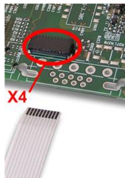
Abbildung 54: CANopen-Aufsteckschnittstelle (AIFX-CO) an die Grundkarte CIFX 104C-FB-R\F anschließen (Beispiel)
